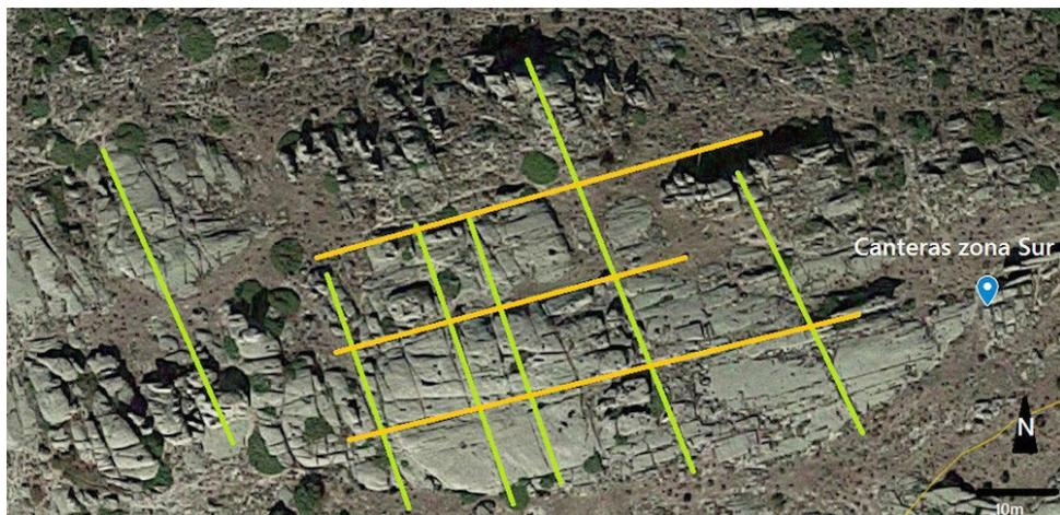
figura 15 - Red de fracturas en los granitos de Ulaca. Se indican dos familias con diferentes direcciones.
